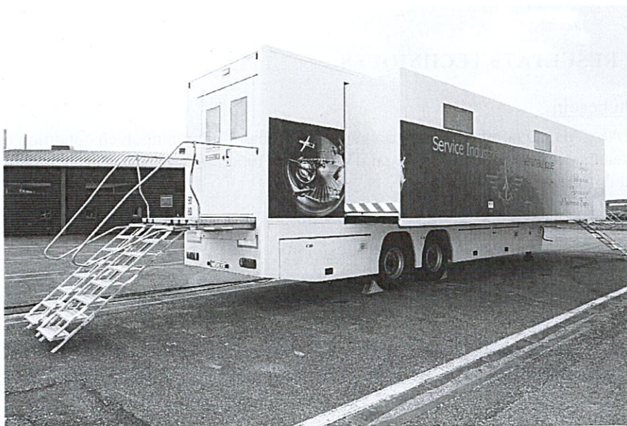
Remorque laboratoire de métrologie mobile déployée
